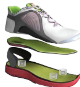
▲ Hình 22P.2. Cấu tạo của đế giày
