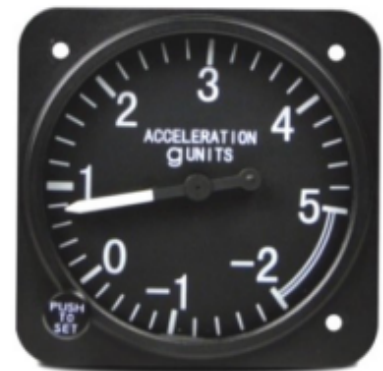
▲ Hình 7.4. Gia tốc kế của máy bay (tính theo gia tốc rơi tự do g)
